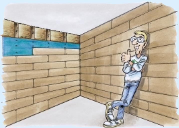
Theo Thermo termine la chambre avec des panneaux en argile Hock, après la pose de l'isolant et du freine-vapeur. Voilà un maître d'ouvrage content.
