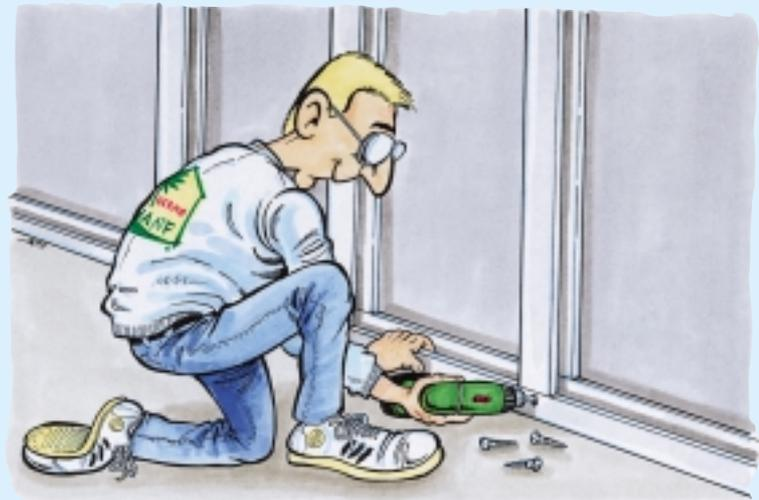
Au rez-de-chaussée, il doit encore monter une cloison et isoler un mur extérieur par l'intérieur. Theo fixe les rails métalliques.
